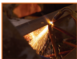
شكل (30) الطاقة الطاردة، من تفاعل الإيثان والأكسجين، تكفي لأعمال اللحام.
