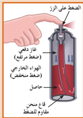
شكل (8) الفرق في الضغط بين داخل عبوة رذاذ الدهان والهواء الخارجي هو أساس آلية عمل مثل هذه العبوات. كيف يكون الضغط داخل العبوة عندما لا تستنك المادة المستخدمة في الدهان من النائر والخروج منها؟
