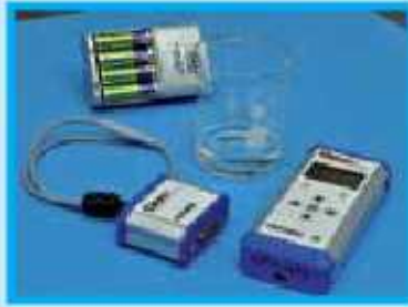
شكل (24) جهاز لقياس درجة التأين في المحلول.
