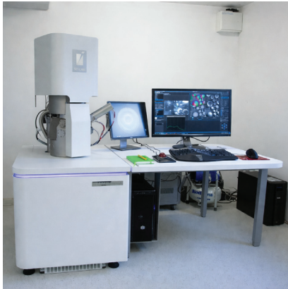
شكل (3 - ب) المجهر الإلكتروني الماسح
