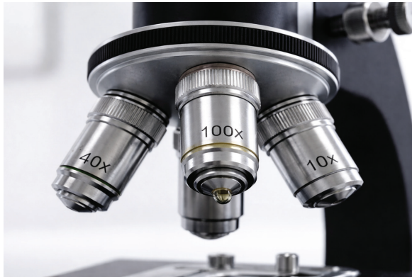
شكل (2 - ب) تنوّع قوّة تكبير العدسات في المجهر الضوئي المركب
