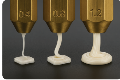
شكل (1): قطر الفوهة Nozzle Diameter
