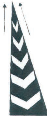
خط المخرج Exit ling
