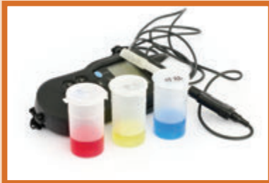
شكل (64) جهاز قياس الرقم الهيدروجيني مع محاليل منظمة لمعايرة الجهاز
